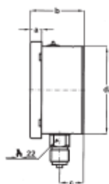
A - RADIAL para montaje local directo
