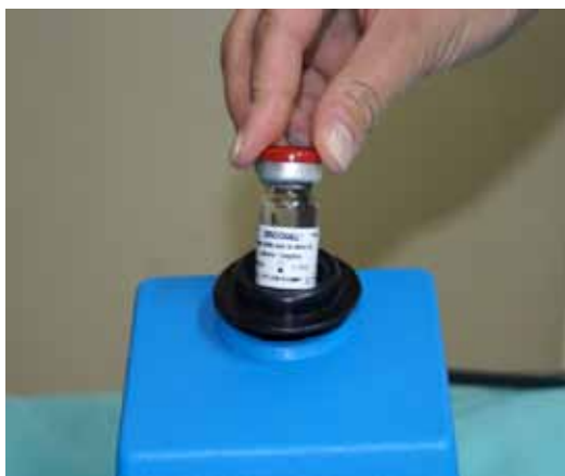
Figura 8. Se agita por 3 minutos el etanol gelificado con tungsteno en suspensión para homogenizar la solución.
